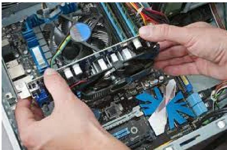
Anche la sostituzione dei pezzi è abbastanza ostica, ma non impossibile. Bisogna prestare molta attenzione a dei piccoli accorgimenti prima di procedere con la sostituzione, come l'utilizzo di un bracciale elettrostatico (o semplicemente toccare qualcosa di ferroso come un termosifone in modo da eliminare piccole cariche che il nostro corpo produce), o come non tenere collegato l'alimentatore alla corrente per non danneggiare i componenti in caso di contatti non voluti.
